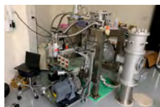
用於研究鍍膜技術的新型低溫系統。
